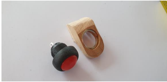
Slika 4.7: Stikalo in ogrodje za stikalo.
