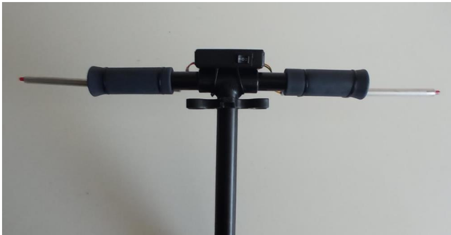
Slika 4.16: Končna namestitev smernikov.
