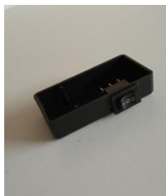
4.14: Ohišje in dvosmerno stikalo.
