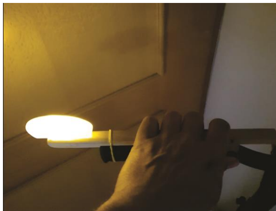
Slika 4.11: Končni izdelek – smernik nameščen na skiro.
