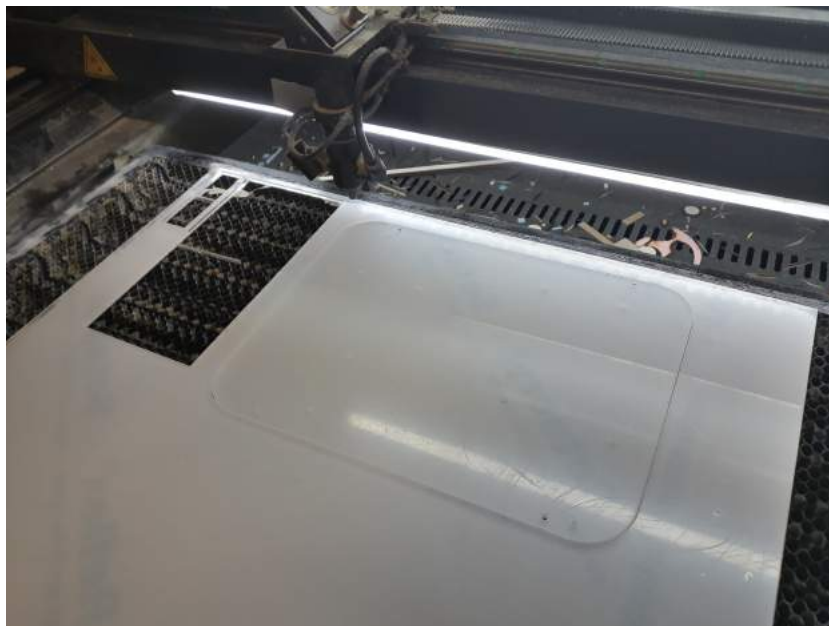
Slika 3.24: Izrez plošče za pritrnitev komponent
