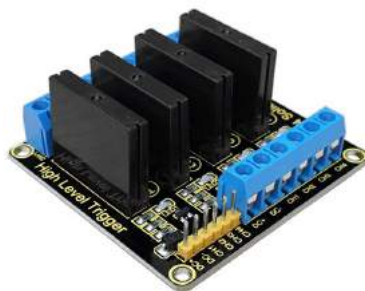
Slika 3.2: Polprevodni štirikanalni rele modul [35]
