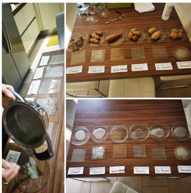
Slika 20: Proces pridobivanja bioplastike (Foto: Jaka Benko)
