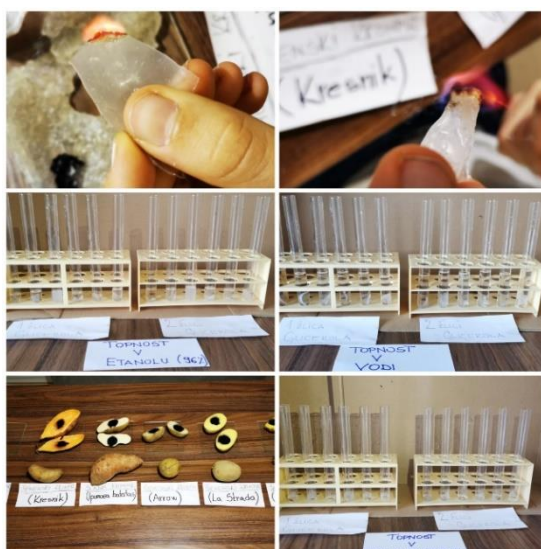
Slika 21: Določanje kemijskih lastnosti nastale bioplastike
