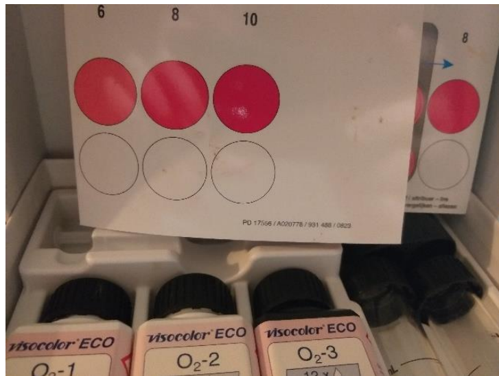
Slika 24: Reagenti in merilna skala za določanje vsebnosti kisika v vodi 46
