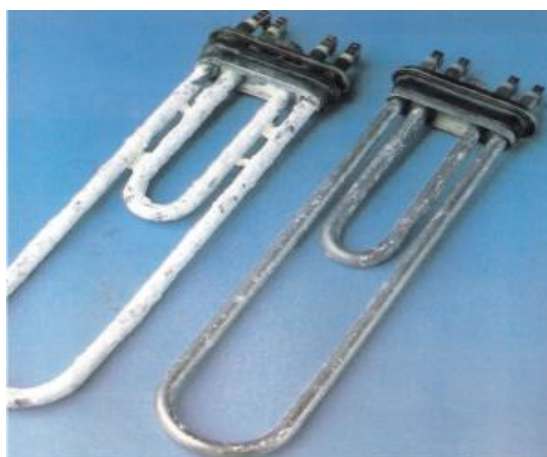
Slika 18: Posledica trde vode na električnih grelcih vode 39
