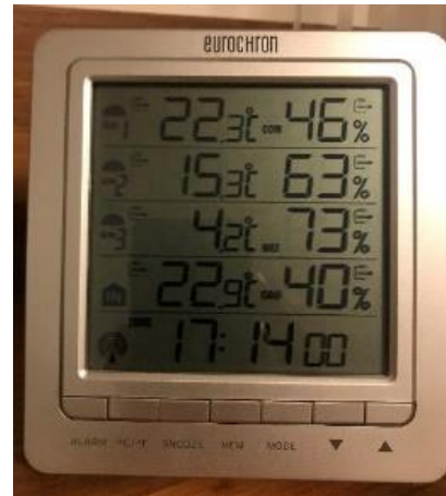
Slika 6: Naprava za merjenje temperature in vlažnosti zraka (foto: Ian Vale, 2. 12. 2020).
