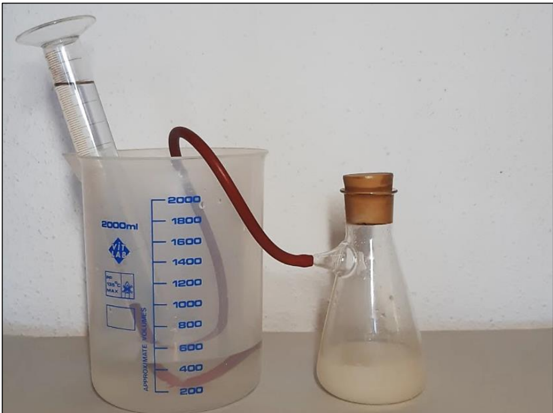
Slika 5: Priprava za spremljanje dinamike nastajanja ogljikovega dioksida med fermentacijo glukoze
