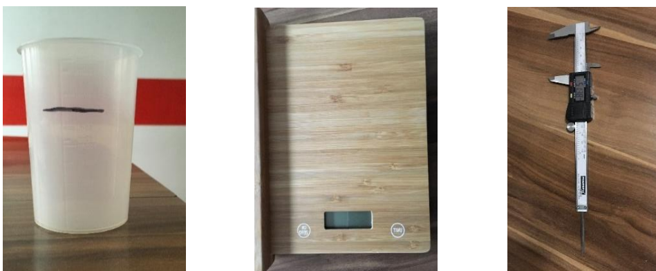
Slika 8: Uporabljeni pripomočki: merilna posodica (levo), kuhinjska tehtnica (v sredini) in pomično ravnilo (desno)
