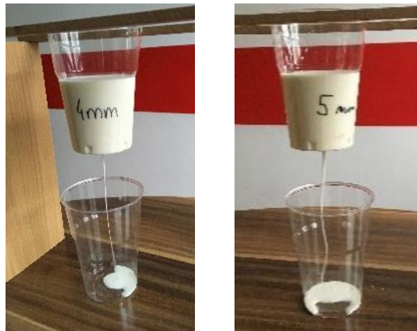
Slika 20: Tok raztopine škroba v kozarčkih z odprtinami različnih premerov
