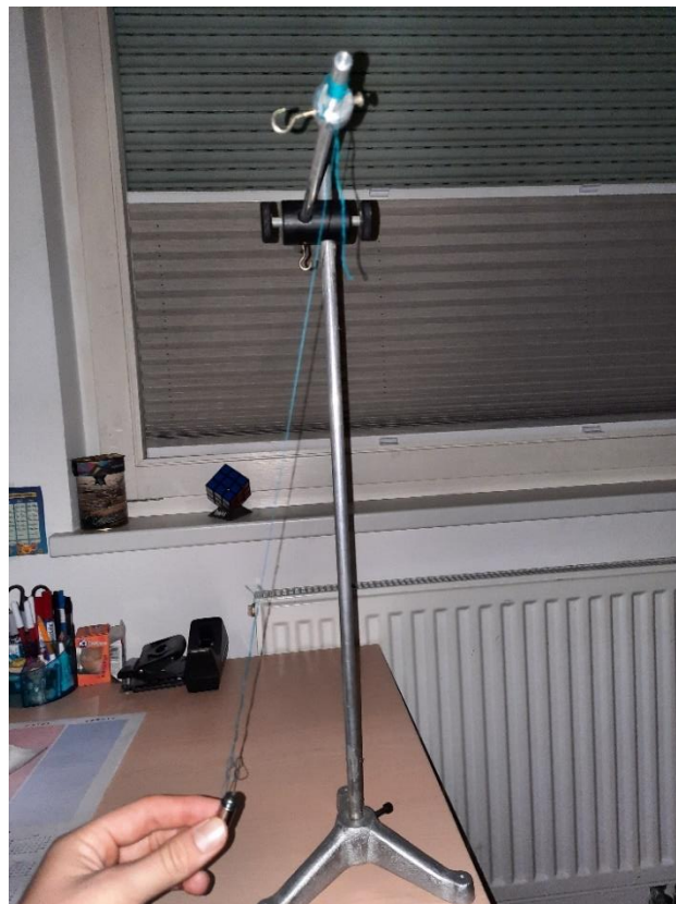
Slika 11: Določanje težnega pospeška z nitnim nihalom
