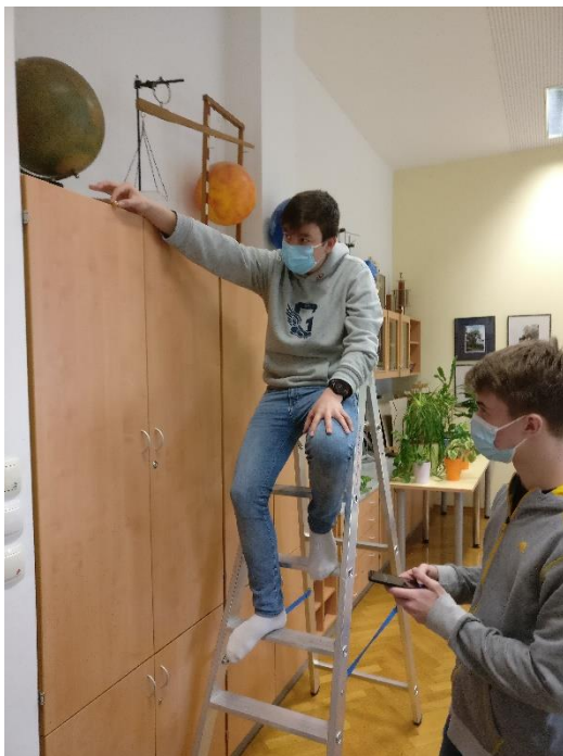
Sliki 2, 3: Merjenje težnega pospeška – prosti pad kroglice z določene višine
