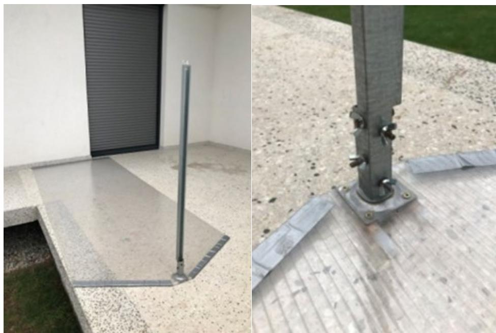
Slika 19: Naprava – sončni koledar, obrnjen proti severu (levo) s sistemom za snemanje palice (desno).
