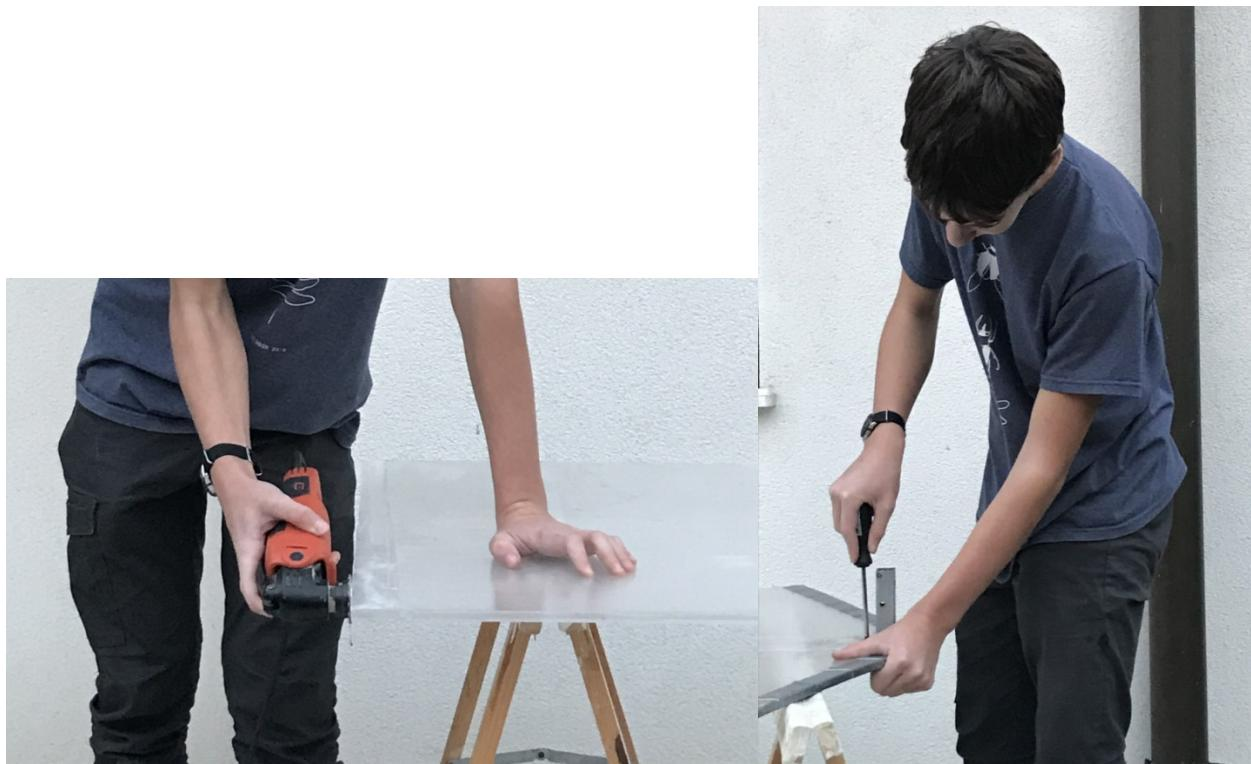
Slika 16: Žaganje polikarbonatne plošče in vijačenje pohištvenega nosilca na ploščo.
