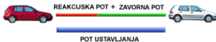
Slika 1: Pot ustavljanja sestavljata reakcijska in zavorna pot
