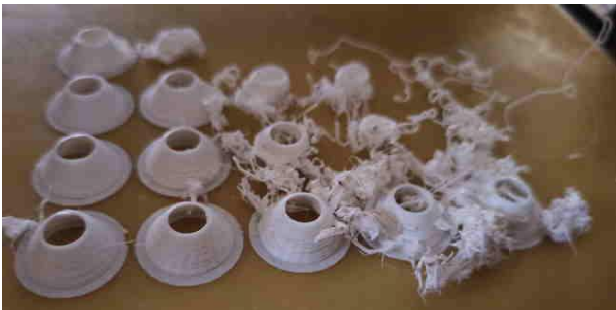
Slika 16: Težave pri tiskanju: filament se ni oprijel podlage (Šimonka, 2020)
