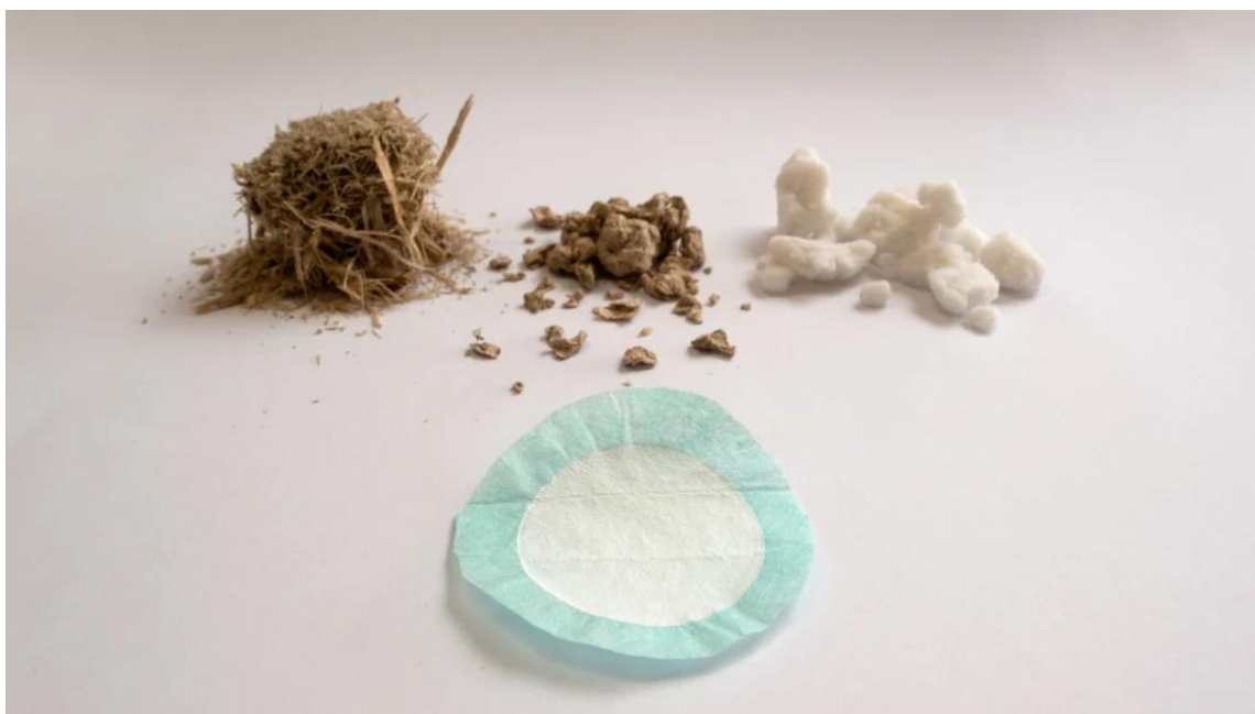
Slika 5: Fotografija uporabljenih materialov za izdelavo biorazgradljive maske.
